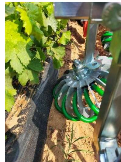
I rotori Rotoblizz sono stati rivestiti con tubolare in gomma per lavorare su telo pacciamante in prossimità della baula senza danneggiamento del telo stesso. La forma arrotondata del rotore e il rivestimento in gomma evitano di strappare e arricciare il telo, sia ad inizio stagione appena steso, sia a stagione inoltrata quando è deteriorato e più sensibile alle lavorazioni. L'applicazione è valida anche su teli di tipo biodegradabile, più delicati e soggetti a rotture.
