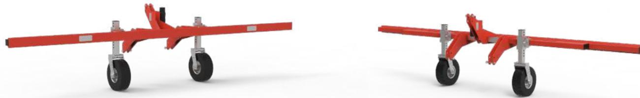
2. **Telaio Fisso con ruote sterzanti, guida manubrio e posto a sedere per l'operatore.**
