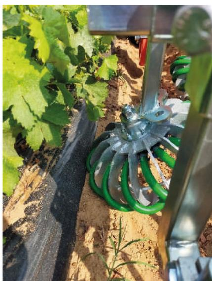
Los rotores Rotoblizz han sido recubiertos con tubos de goma para poder trabajar sobre la película de plástico en las proximidades del caballón sin dañarla. La forma redondeada del rotor y el revestimiento de goma evitan que la película se desgarre y se encespe, ya sea al principio de la temporada, cuando se acaba de colocar, o más adelante, cuando se ha deteriorado y está más sensible a los TRABAJOS.
