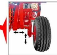
Le due **ruote stabilizzatrici**, sono regolabili in altezza e in larghezza
