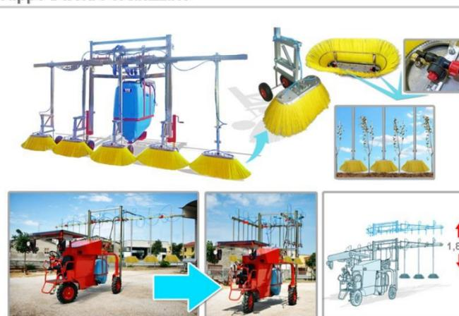
Il singolo elemento è costituito da un parallelogramma a molle, la campana localizzatrice personalizzabile, dove sono disposti i getti tipo TRIJET con gli anti goccia. Il prodotto viene erogato in un'area delimitata, grazie alla spazzola perimetrale di setole di nylon, sulla campana localizzatrice.
