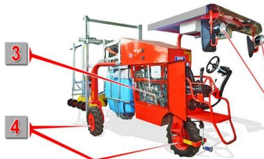
Il Trampolo Pony 2000 monta un motore Lombardini 4 cilindri da 33 HP raffreddato a liquido (3), che alimenta i motori idrostatici (4) che muovono la macchina.
