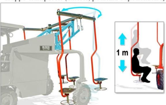
Applicata al sollevatore, è costituita da bracci basculanti con 5 sedute girevoli su se stesse, che si sollevano idraulicamente fino a un 1 mt dal suolo. Gli operatori seduti, eseguono manualmente l'innesto.
