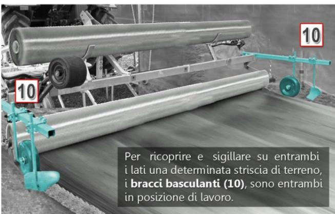
Per ricoprire e sigillare su entrambi i lati una determinata striscia di terreno, i **bracci basculanti (10)**, sono entrambi in posizione di lavoro.
