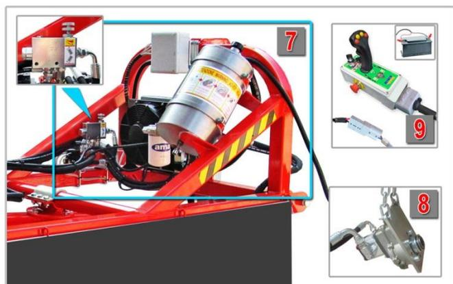
La **Spazzolatrice SXC** è munita di **impianto elettro/idraulico autonomo (7)**, con serbatoio olio, scambiatore di calore, un **regolatore di velocità delle spazzole**.
