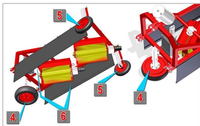
Per **fissare in altezza** la posizione delle spazzole, la macchina dispone di un **livellatore gommato (4)** ad **altezza variabile**.
