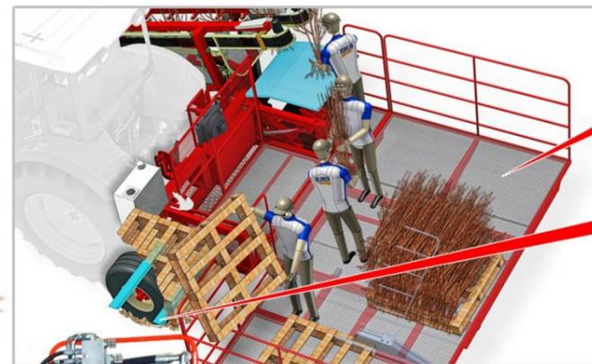
La scavapiante SP2000, monta una **pedana** sulla quale gli **operatori** eseguono la cernita delle piante o lo stoccaggio su pallet.
