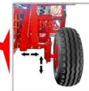
Le due **ruote stabilizzatrici**, sono regolabili in altezza e in larghezza.
