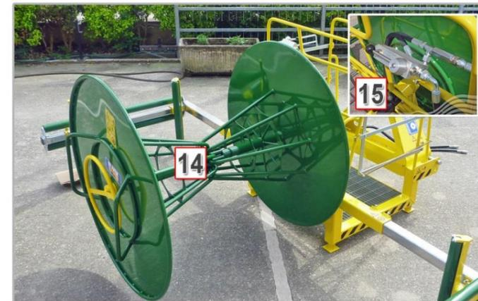
Il **rullo avvolgi bobina (14)** è mosso da un **motore idraulico** alimentato direttamente dall'impianto idraulico del trattore. È possibile regolare la velocità di rotazione, grazie a un **regolatore di flusso a leva (15)** posto nella console di comando dell'operatore.
