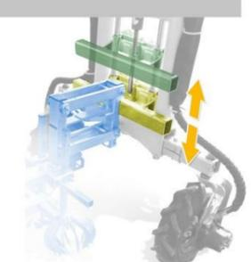
Attacco interno costituito da una barra quadra per il fissaggio degli elementi rotosark con escursione verticale di 300 mm.
