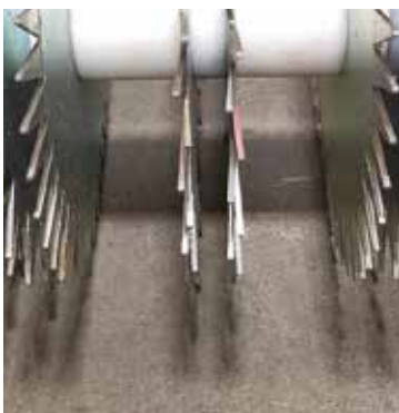
Figura 2 Colibrì, Dientes inclinados (distancia entre filas de 6 a 7 cm)
